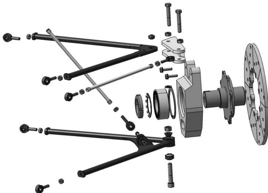
Explosionszeichnung der Radaufhängung des SRC-01
